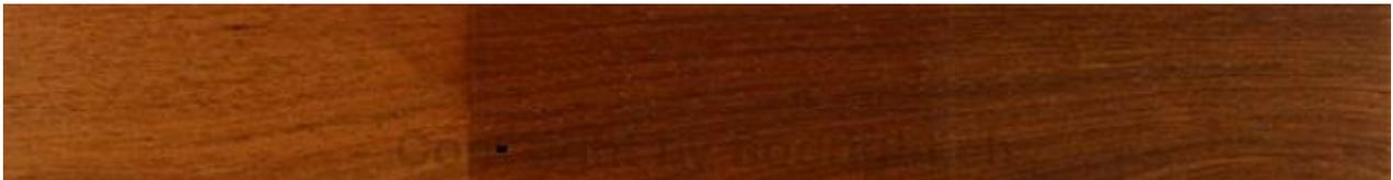
Links: 12 Mt vor UV Strahlen geschützt / Mitte: nur die ersten 6 Mt Schutz geschützt (Farbangleichung) / Rechts: permanente UV-Bestrahlung über 12 Mt
