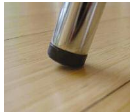
Ungünstige Geometrie führt zu hoher Punktlast
