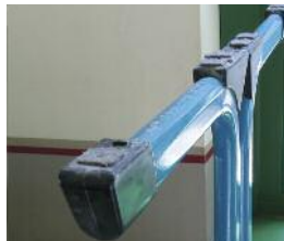
Scharfkantige, beschädigte, abgenutzte und ungeeignete, verschmutzte Stuhlgleiter
