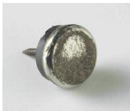
Metallgleiter mit Schmutzanhaftungen nach siebenmonatiger Nutzung
