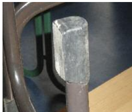
Scharfkantige, beschädigte, abgenutzte und ungeeignete, verschmutzte Stuhlgleiter
