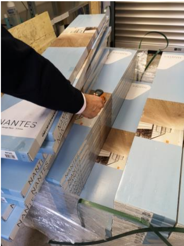
Abbildung 5: Messung an den Paketen in der Mitte der Palette
