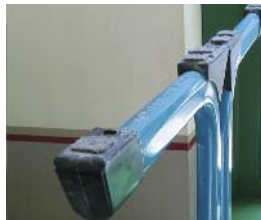
Scharfkantige, beschädigte, abgenutzte und ungeeignete, verschmutzte Stuhlgleiter
