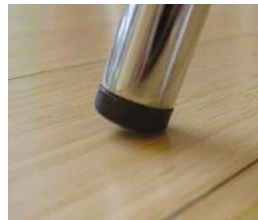
Ungünstige Geometrie führt zu hoher Punktlast
