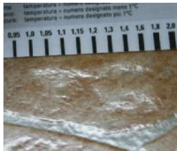
Bleibende Eindrücke durch hohe Punktlast und harte Gleiter
