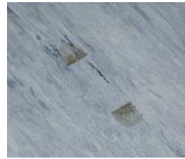
Verfärbung und Eindrücke durch ungeeignete Rollen
