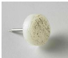
Stark geschädigter Nylongleiter nach drei- bis viermonatiger Nutzung
