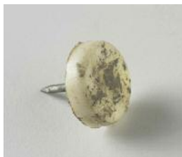
Nylongleiter mit starker Schmutzanhaftung nach achtmonatiger Nutzung
