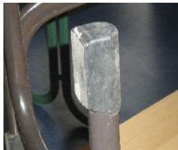
Scharfkantige, beschädigte, abgenutzte und ungeeignete, verschmutzte Stuhlgleiter
