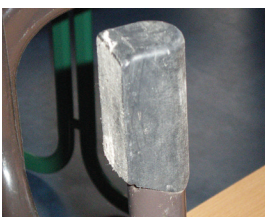
Scharfkantige, beschädigte, abgenutzte und ungeeignete, verschmutzte Stuhlgleiter
