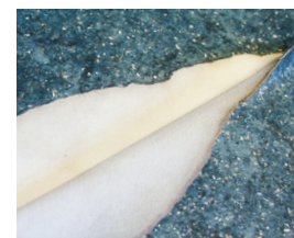
Delaminierung nach Überbeanspruchung durch Stuhlrollen
