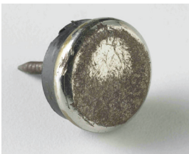
Metallgleiter mit Schmutzanhaftungen nach siebenmonatiger Nutzung
