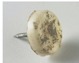
Nylongleiter mit starker Schmutzanhaftung nach achtmonatiger Nutzung
