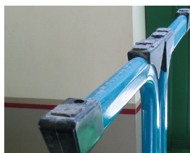
Scharfkantige, beschädigte, abgenutzte und ungeeignete, verschmutzte Stuhlgleiter
