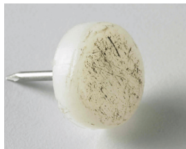
Stark geschädigter Nylongleiter nach drei- bis viermonatiger Nutzung
