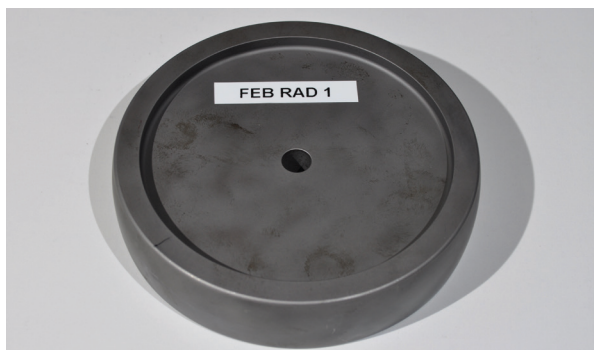
Abb. 3: Testrad aus Stahl (Referenzrad) [2]
