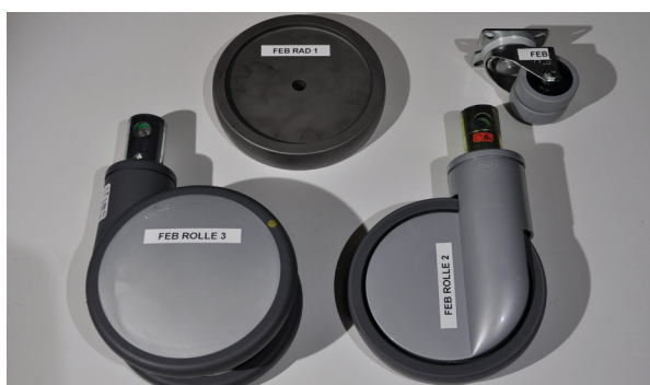
Abb. 7: Räder u. Rollen der Testreihen [2]
