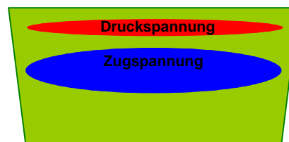
Bild 1: Die warme Zone hat eine grössere thermische Ausdehnung. Es entstehen Spannungen.
