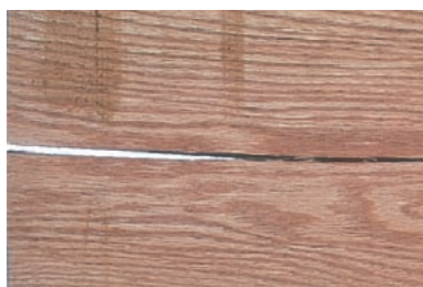
DURCHGEHENDER RISS Längstrennung der Holzfasern, die beim Trocknen des Holzes entstehen kann (auch: Endriss).
