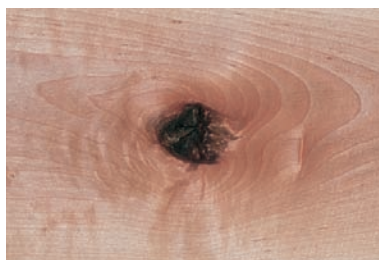
FAULAST Runde Fläche, die ursprünglich den Querschnitt eines Astes oder Zweiges bildete. Das Zentrum des Astes ist die Markröhre. Fällt das faule Zentrum des Astes heraus, ergibt sich ein Astloch.
