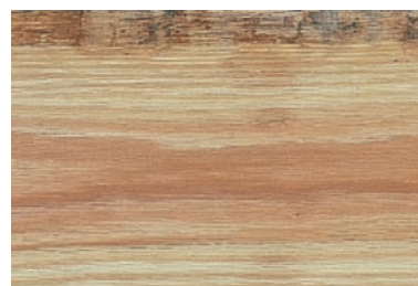
BAUMKANTE Auch Fehl- oder Waldkante: Der am besäumtem Schnittholz verbliebene Teil der Stammoberfläche.
