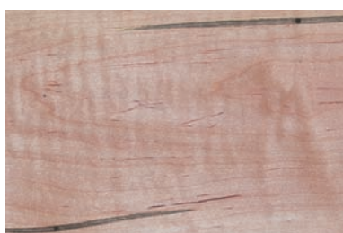
WURMLÖCHER Löcher im Holz, zwischen 1/16" und 1/4" groß (1,6 mm bis 6,4 mm Durchmesser).
