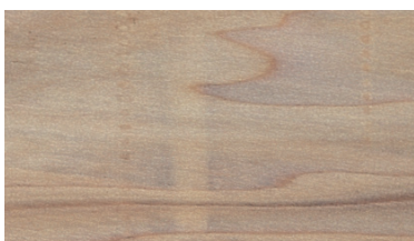
STAPELATTENMARKIERUNG Verfärbungen, die durch Stapellatten beim Trocknen des Holzes entstehen und meist durch Hobeln entfernt werden können.
