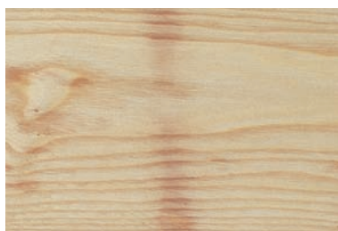
STAPELLATTENVERFÄRBUNG Meist graue Verfärbung, die durch feuchte Stapellatten bei der Holz Trocknung verursacht wird.
