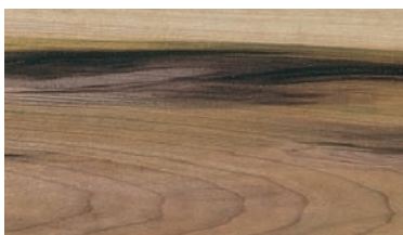
MINERALSTREIFEN Streifenförmige, oliv bis schwarz-braune Verfärbungen, parallel zum Faserverlauf.
