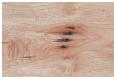
VERLETZUNGEN DURCH VÖGEL Kleine Unregelmäßigkeiten im Faserverlauf - auch mit Rindeneinschluss -, hervorgerufen durch die Schnäbel von Vögeln bei der Suche nach Insekten. Für American hickory und American elm gibt es Ausnahmeregeln.
