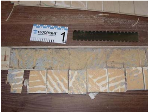
Gute Benetzung mit vorgegebener Herstellerzahnung.
