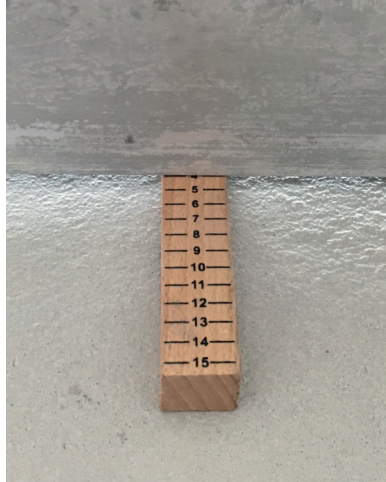
Estrichfläche nach DIN 18202 Tab. 3, Zeile 4
