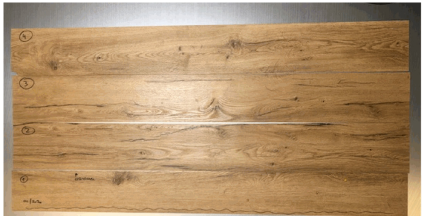
Bananenbildung aufgrund fehlender Akklimatisation, Bilder: Floorright AG
