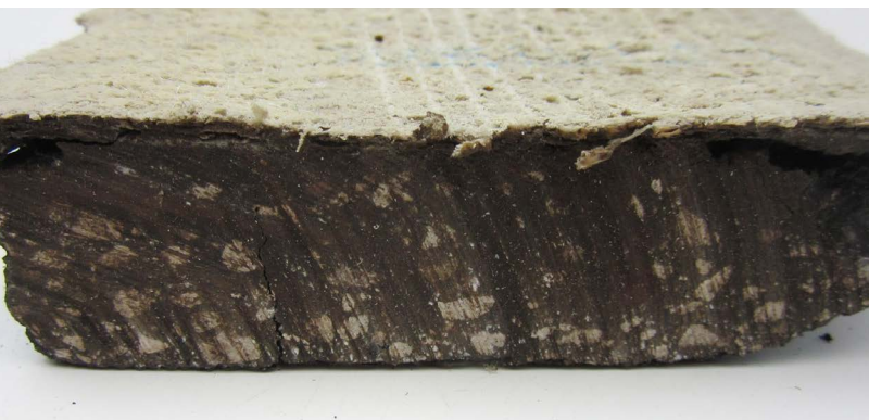
Probestück Gussasphaltestrich für die Laboruntersuchung
