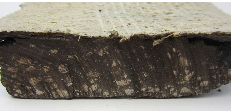
Échantillon de chape en asphalte coulé pour l'analyse en laboratoire
