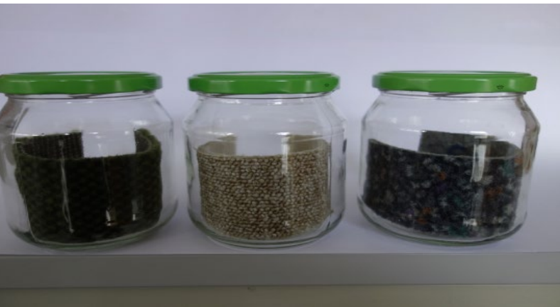
Geruchs-Vorprüfung von Bodenbelägen mit einfachen Schraubdeckelgläsern
