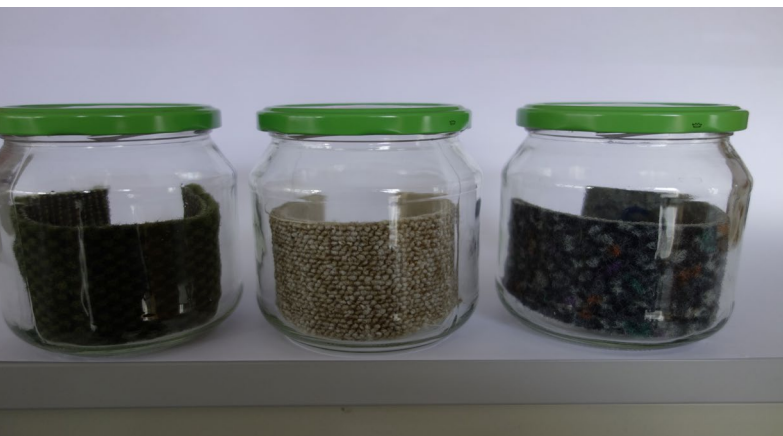
Contrôle préalable des odeurs des revêtements de sol avec de simples bocaux à couvercle vissé
