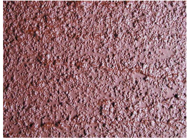
Produkt 3b: Antirutsch-Anstrich SAFE STEP 200 (SETON); Zweikomponenten-Masse mit Aluminiumoxidkörnern. Bildausschnitt 8 cm x 6 cm.
