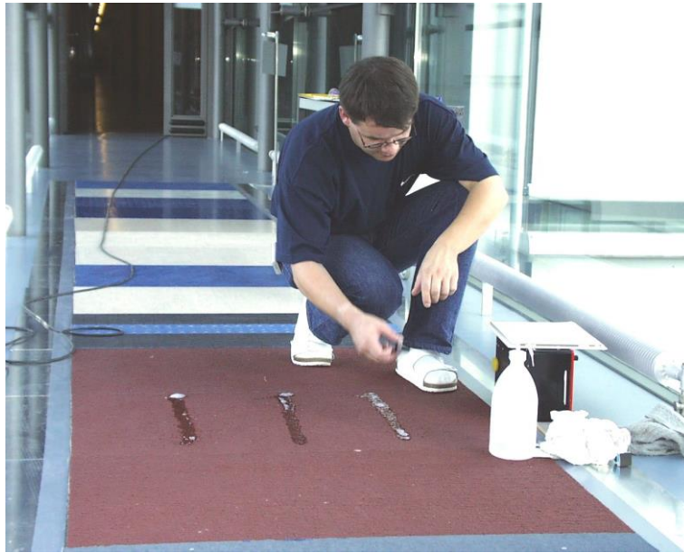
Abbildung 3.2: Messung von Gleitreibungskoeffizienten mit dem Gerät FSC 2000. Die Oberfläche eines Musters wird an mehreren Stellen und im nassen Zustand untersucht.
