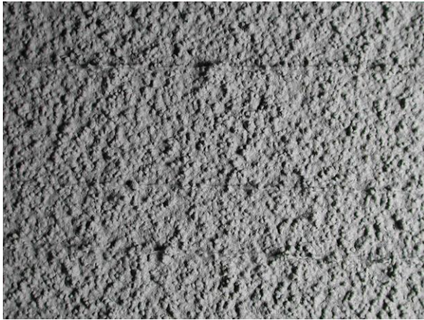
Produkt 3a: Antirutsch-Anstrich SAFE STEP 100 (SETON); Einkomponenten-Masse mit Aluminiumoxidkörnern. Bildausschnitt 8 cm x 6 cm.
