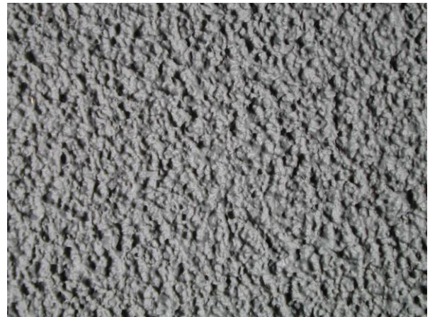
Produkt 4b: Gleitschutzklebeband Safety Walk Resilient, mittel, mit Kunststoffgranulat (3M). Bildausschnitt 4 cm x 3 cm.
